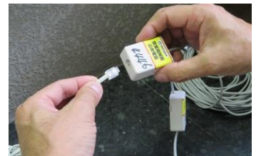
〔2〕 災害時、自治体様が管理している電話機とモジュラージャックを電話コードで接続します。
