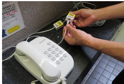
〔2〕 災害時、自治体様が管理している電話機とモジュラージャックを電話コードで接続します。
