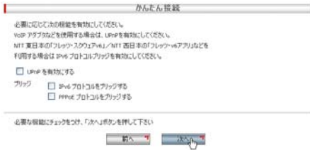
図 5.0.14 固定 IP アドレス接続で使用する機能
