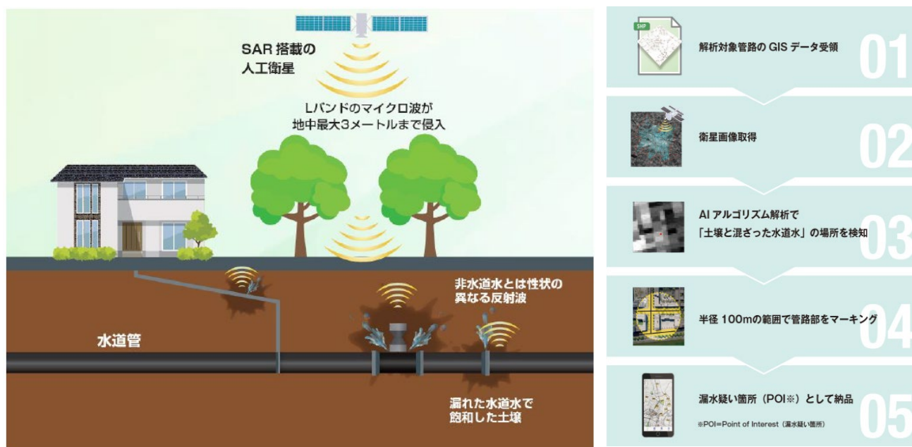
【図 3 : デジタル機器による広範囲に漏水挙動（漏水疑似音）を検知する技術】
