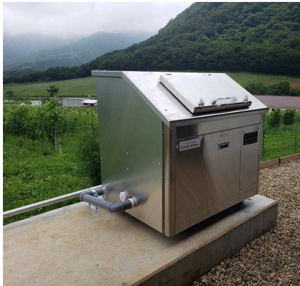
有機系資源の発生現場に設置された 食品残渣発酵分解装置（フォースターズ）
