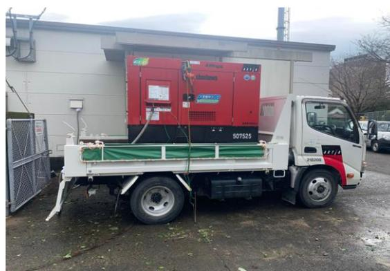
長時間停電が発生し、予備電源も停止した場合、最大1,000kVAの発電能力を備えた移動電源車等により通信電源を確保します
