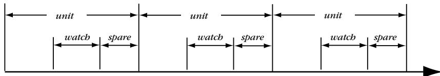
*watch* で示した間だけトラフィックを監視し、この間にパケットが流れなければ回線を切断する。*spare* は切断処理に時間がかかりすぎて、実際の切断が単位時間と越えないように余裕を持たせるために使う。回線を接続している時間が *unit* の倍数になるので、単純トラフィック監視方式よりも通信料金を減らす効果が期待できる。
