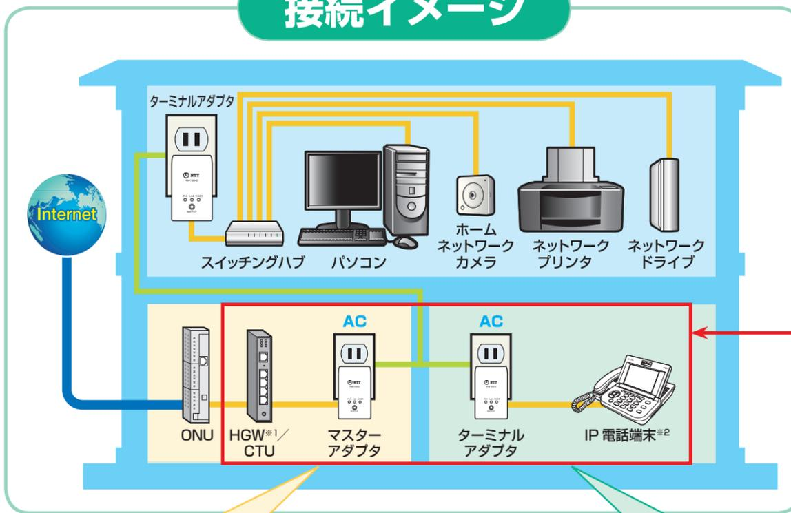
PLCアダプタはフレッツ光ネクストでは『HGW』と『IP電話端末』、フレッツ光プレミアムでは『CTU』と『ひかり電話対応機器』との間で利用
