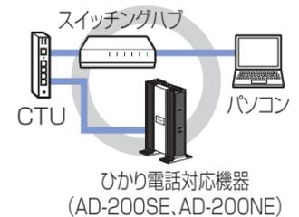
●CTU とひかり電話対応機器の間には他の機器 (スイッチングハブ、ルータ等) を接続しないでください。
