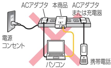
●電化製品とPLCアダプタを同一電源コンセントに接続しない
