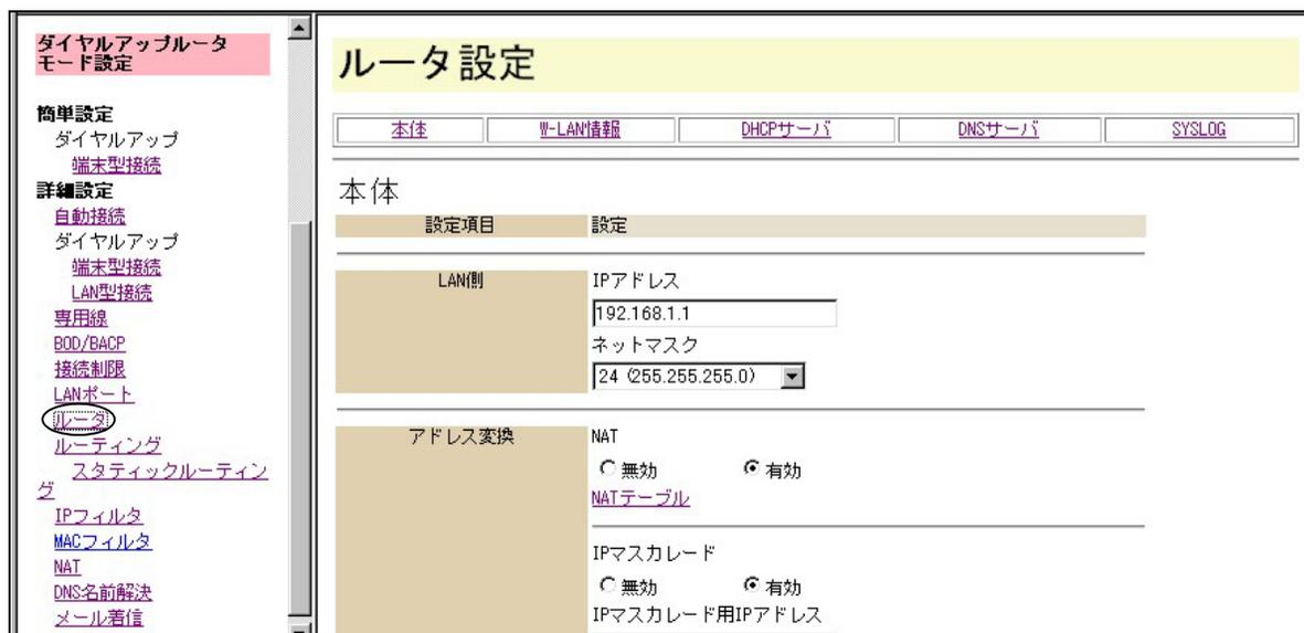
ルータ設定は、「ゲートウェイ情報」「ワイヤレス LAN 情報」「DHCP サーバ」「DNS サーバ」「SYSLOG」の項目に分類されています。
