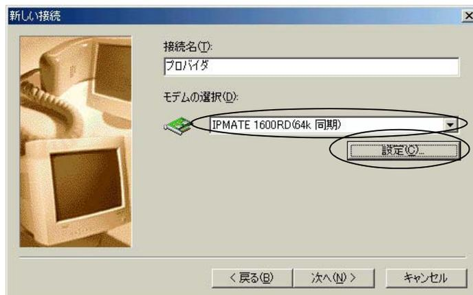
IPMATE1600RD では、通信速度に従って以下の 4 種類のモデムを選択することができます。
