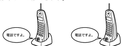
呼び出された方は、どのコードレス電話機からも応答することができます。応答があると、主電話機のディスプレイには、応答したコードレス電話機の内線番号が表示されます。増設したコードレス電話機も同時に呼びかけることができます。
