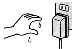
ぬれた手で電話機を操作したり、ぬれた手で乾電池および電池パックを交換しないでください。感電の原因となることがあります。
