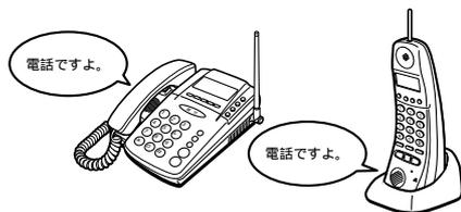
呼び出された方は、主電話機からもコードレス電話機からも応答することができます。応答があると、コードレス電話機のディスプレイには、応答した電話機の内線番号が表示されます。増設したコードレス電話機も同時に呼びかけることができます。
