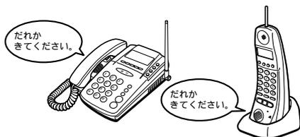
呼び出された方は、主電話機からもコードレス電話機からも応答することができます。応答があると、呼び出したコードレス電話機のディスプレイには、応答した電話機の内線番号が表示されます。
