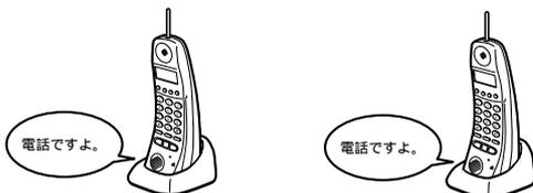
呼び出された方は、どのコードレス電話機からも応答することができます。応答があると、主電話機のディスプレイには、応答したコードレス電話機の内線番号が表示されます。増設したコードレス電話機も同時に呼びかけることができます。
