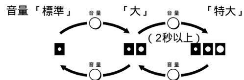
スピーカの音量を調節するには（スピーカ音量）音量ボタンを押すと音量が大きくなります。音量は3段階で切り替えることができます。お買い上げ時は「中」に設定されています。
