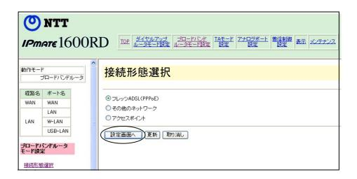
☑ 「PPPoE 接続」 - 常時接続を選択し、「ユーザー名」、「パスワード」にご契約のプロバイダから指定された内容を設定し「更新」をクリックします。
