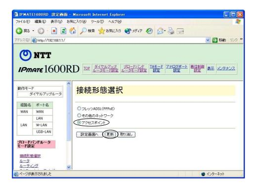
四 再度「接続形態選択」画面を表示し、「アクセスポイント」が選択されていることを確認して「設定画面へ」をクリックします。
