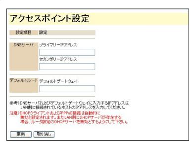
• DNS サーバ及びデフォルトゲートウェイアドレスは LAN 側に接続されているサーバ (ホストコンピュータ) の IP アドレスを指定します。
