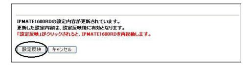
設定完了後、IPMATE1600RD が再起動されます。本商品の正面ランプが全て橙色で点灯後、 ブロードバンドモードの通常表示状態になったらお使いいただけます。
