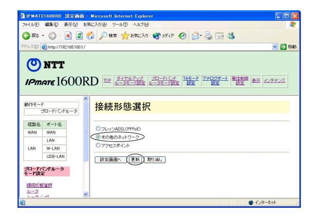
四 再度「接続形態選択」画面を表示し、「その他のネットワーク」が選択されていることを確認して「設定画面へ」をクリックします。
