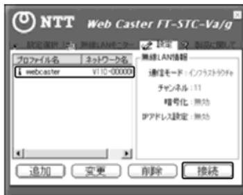
11 手順10で表示されている画面上部の「設定選択」タブをクリックし、「詳細…」をクリックします。詳細情報が表示されますので「無線LAN情報」の信号強度と通信品質が表示されていることを確認した後、ウィンドウを閉じます。
