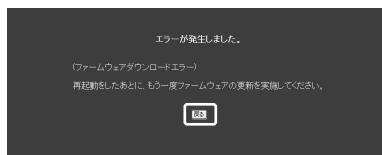
※「装置状態表示」画面のアップデート状態は、「ファームウェアの更新に失敗しました。」を表示します。
