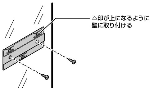
②本商品を、横にスライドさせて固定させます。この時、力をかけすぎると本商品および壁が破損する恐れがありますので注意してください。
