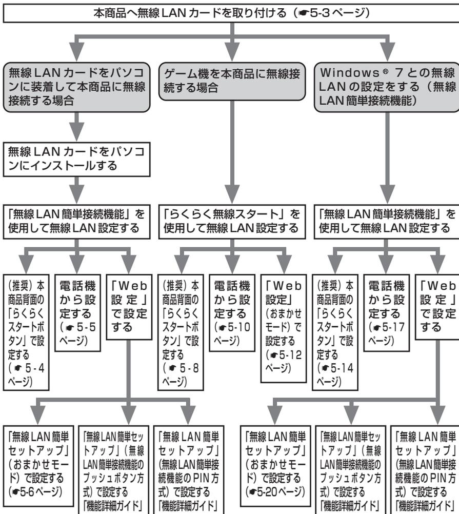
おまかせモードを起動すると、設定する無線 LAN 端末の設定モードに合わせて、「無線 LAN 簡単接続機能 (プッシュボタン方式)」または「らくらく無線スタート」で設定を開始します。本書では、おまかせモードを使用した設定方法を記載しています。
