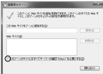
6 [この Web サイトをゾーンに追加する] に [http://ntt.setup/] もしくは本商品の IP アドレス [http://192.168.1.1/] (工場出荷時) を入力して [追加] をクリックし、[閉じる] をクリックする
