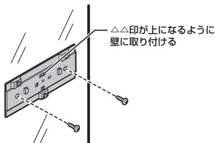
②本商品をスライドさせて固定させます。このとき、力をかけすぎると本商品および壁が破損する恐れがありますので注意してください。
