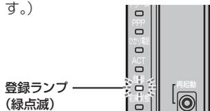
! 設定中に「設定に失敗しました。再度設定してください。」と音声ガイダンスが流れ、アラームランプが 10 秒間赤点滅した場合は、設定に失敗しています。（☛5-7 ページ）
