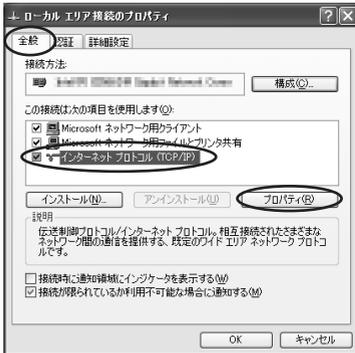
5 [IP アドレスを自動的に取得する] と [DNS サーバーのアドレスを自動的に取得する] を選択する
