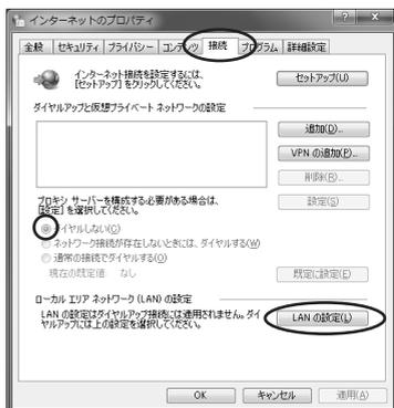
5 [設定を自動的に検出する]、[自動構成スクリプトを使用する]、[LANにプロキシサーバーを使用する]のチェックを外し、[OK] をクリックする
