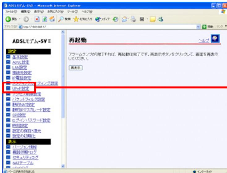
前面のアラームランプ(赤色)が消えて再起動が完了したことを確認後、画面左側メニューの「UPnP設定」をクリックする。
