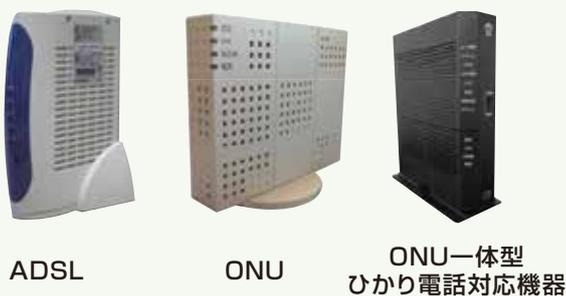
図11 フレッツ端末機器
