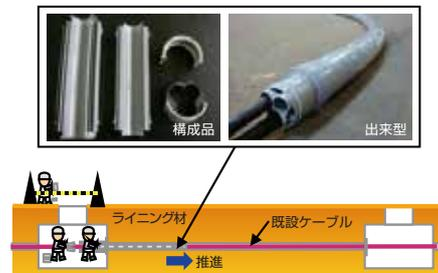
既設ケーブルを挟みこみながら短尺のライニング材を接続、管内挿入し、新たなケーブル収容空間(3,000心)を確保する技術です。
