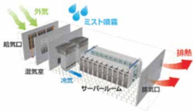
ミスト併用直接外気空冷システム(仮称)
