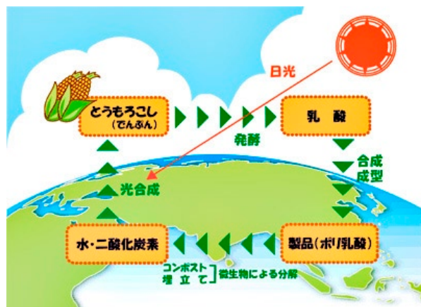
図1 植物由来の生分解性プラスチックの自然循環図
