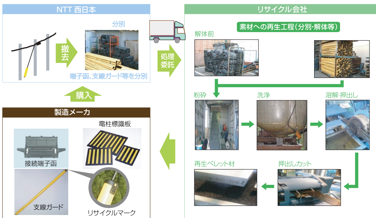
図5 プラスチック製品のクローズドループリサイクルフロー
