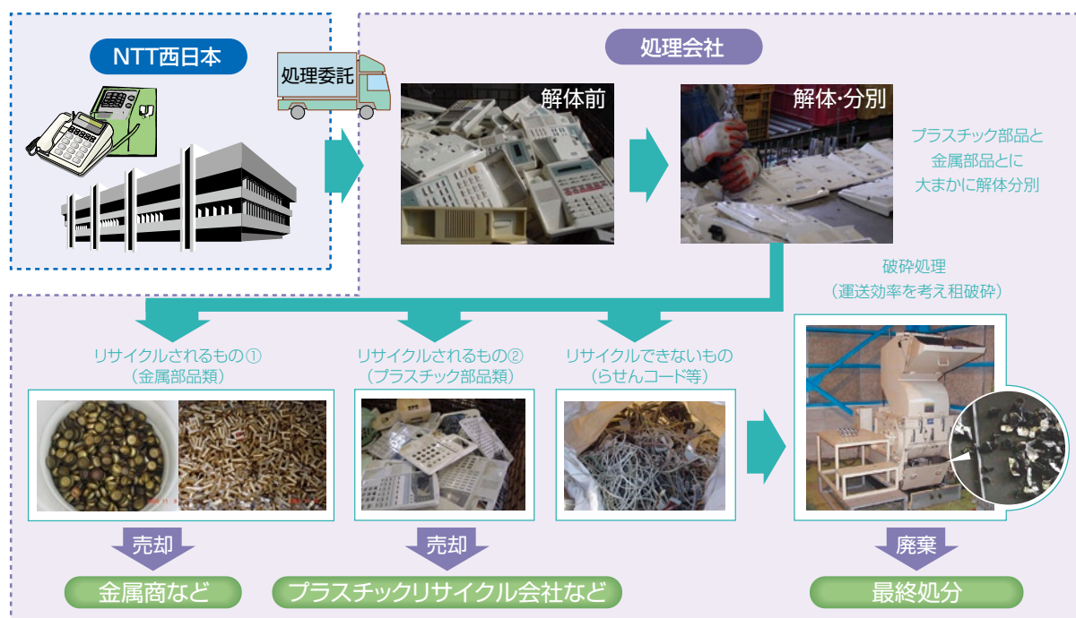
図5 電話機等端末機器の処理フロー
