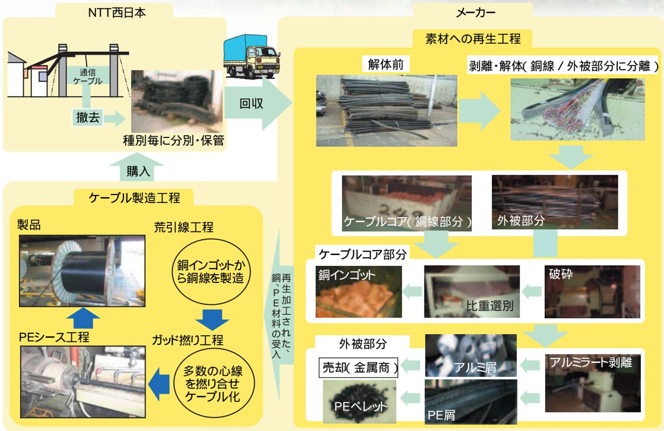
図7 交換機等装置類の処理フロー
