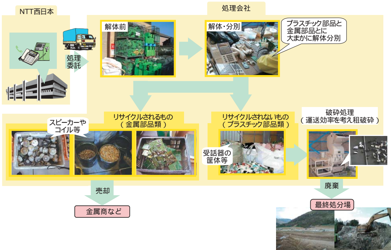
図2 電話機等端末機の処理フロー
