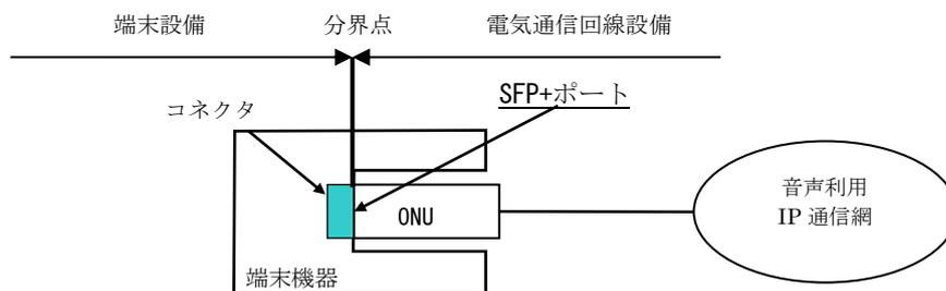
図 2-2-1 : 端末設備と電気通信回線設備との分界点
