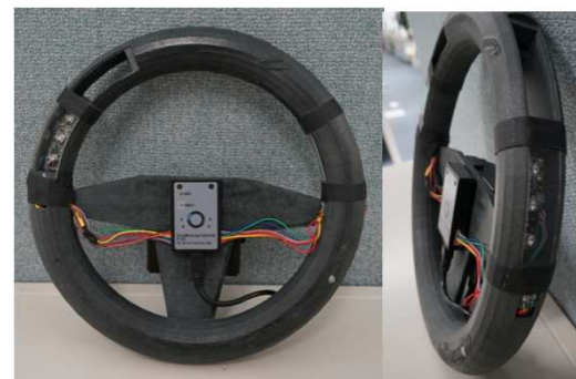
4つのセンサを組み込んだステアリング簡易モックアップ
