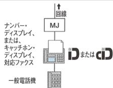
電話用コンセント（モジュラージャック「MJ」）にナンバー・ディスプレイ対応ファクスの電話機コードを接続します。ファクスの外付電話機端子に一般電話機の電話機コードを接続します。
