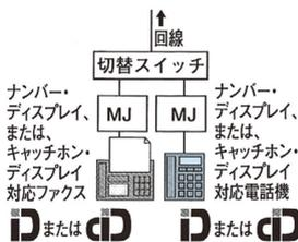
ナンバー・ディスプレイ対応端末を2台接続する場合、切替スイッチを設置することで対応できます。切替スイッチから出ているそれぞれの電話用コンセント（モジュラージャック「MJ」）にファクス・電話機などを接続します。
