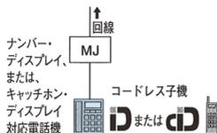
電話機用コンセント（モジュラージャック「MJ」）にナンバー・ディスプレイ対応電話機を接続します。電話機にコードレス子機がセットになっている場合は、親機を接続します。
