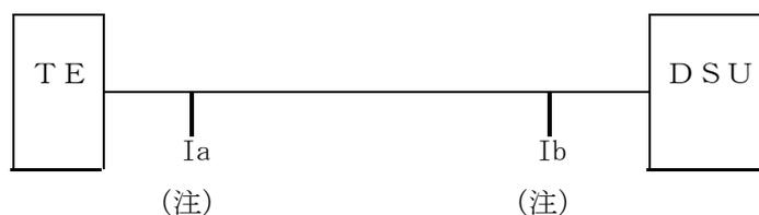
(注) Ia及びIbは、TE/DSUの入出力ポートに位置します。
