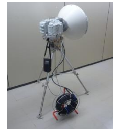
災害対策用無線システム
