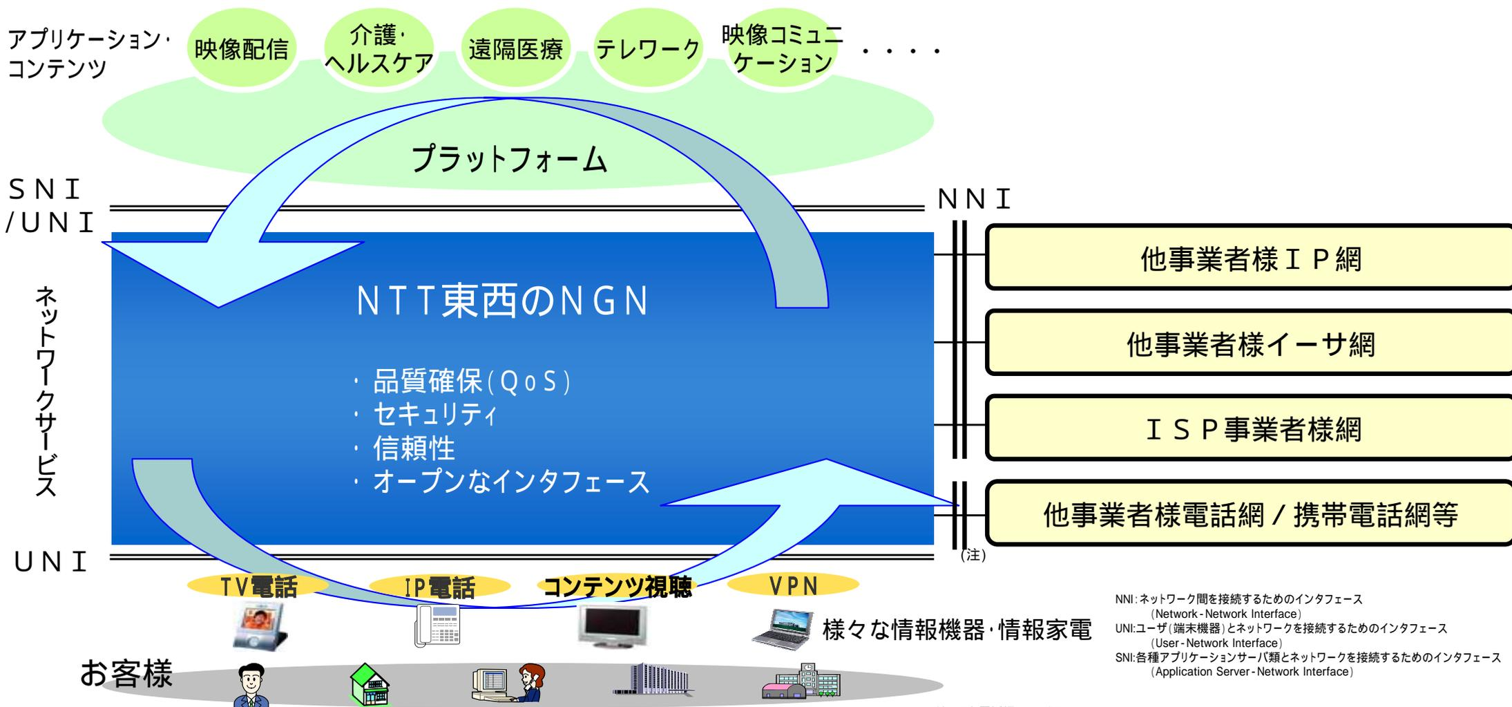
NGNでは、地域IP網で実現していた従来のベストエフォート型の通信に加えて、ネットワーク制御によりエンド・トゥ・エンドでの品質を確保したサービスを提供します。
