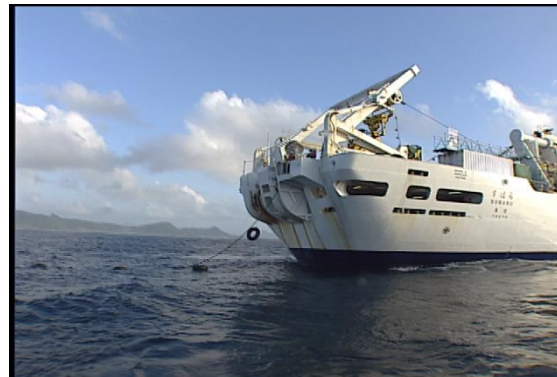
船舶の錨などによって海底ケーブルが損傷を受けたため、ケーブル敷設船が現場に急行し、切断箇所を確認
