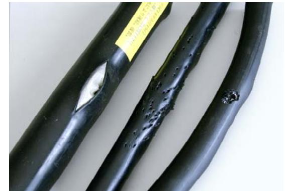
散弾銃やキツツキの被害にあった電話ケーブル
