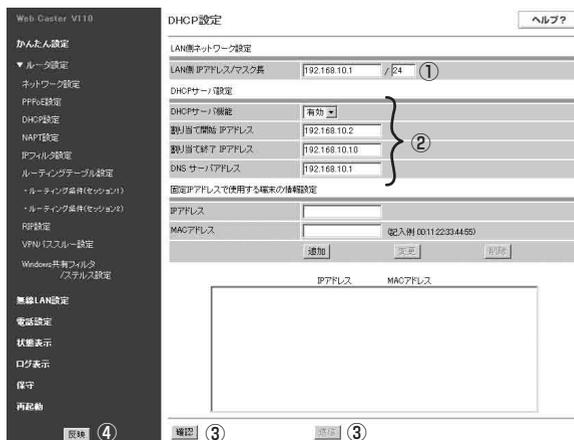
① 「LAN側ネットワーク設定」の「LAN側IPアドレス/マスク長」は「192.168.10.1/24」を入力します。
