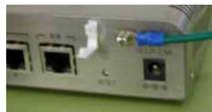
②電源コード用クランプ取り付け状態
