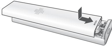
電池パックのコードをはさまないように電池カバーを水平にかぶせる
