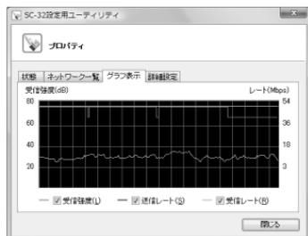
※現在の電波状態をグラフで表示します。表示したい項目のチェックボックスにチェックしてください。
