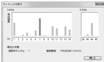
近くの無線LANアクセスポイントが、どのチャンネルで使われているかを表示します。現在、接続中のチャンネルは赤で表示されます。
