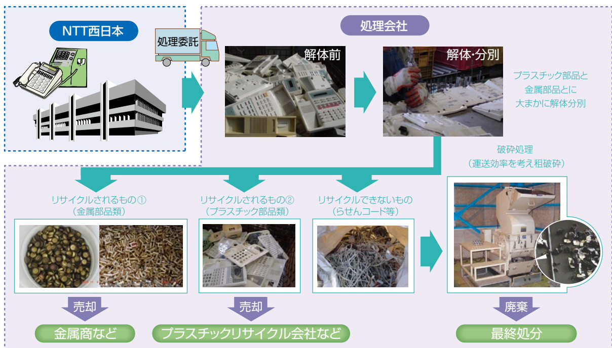
図5 電話機等端末機器の処理フロー
