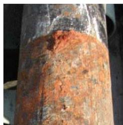
土中で腐食した鋼管柱
