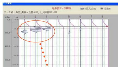
測点1.2.3.において、大きな波形が起生しており、ひび割れがあると判定できる。
