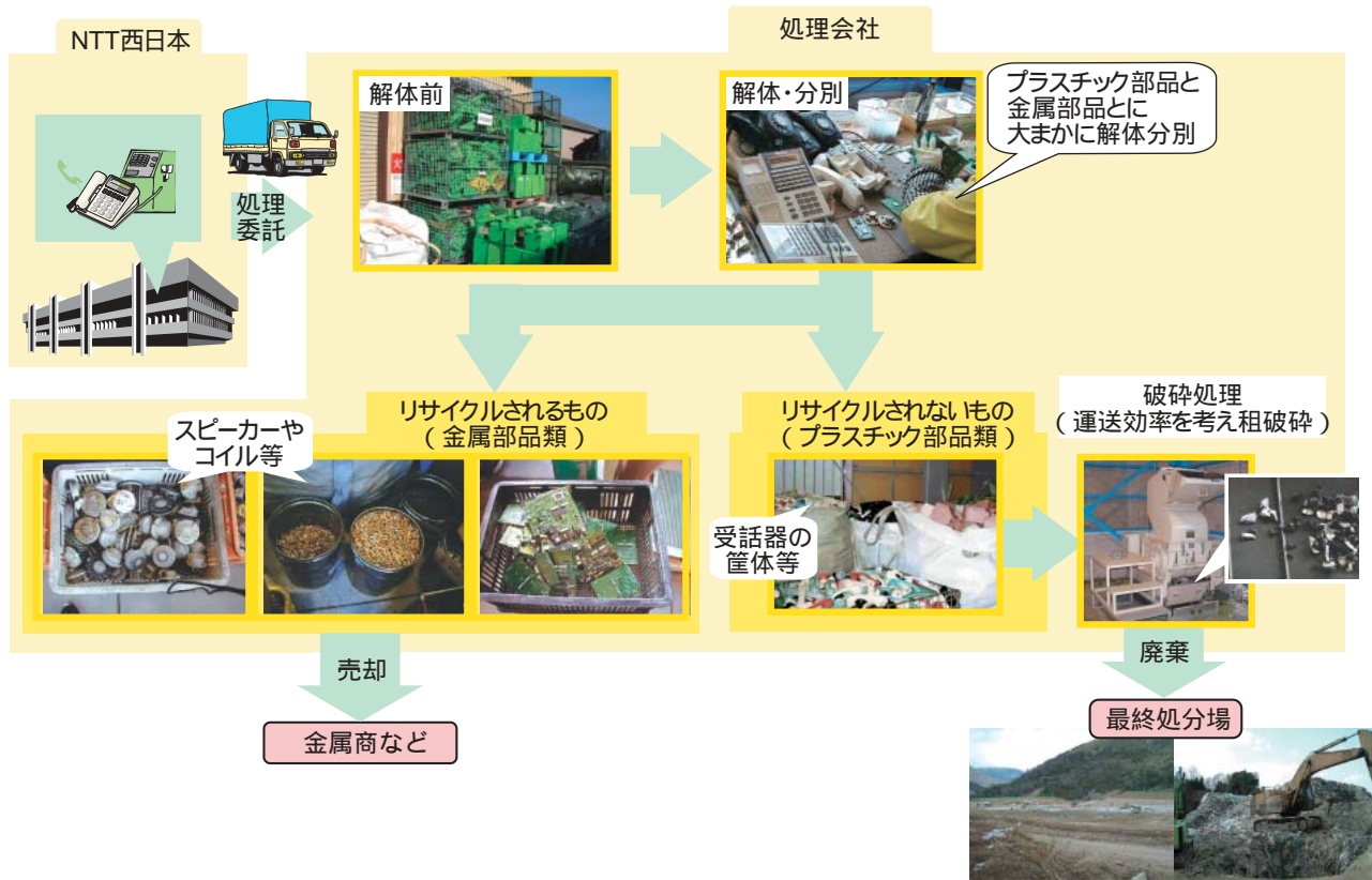
図2 電話機等端末機の処理フロー
