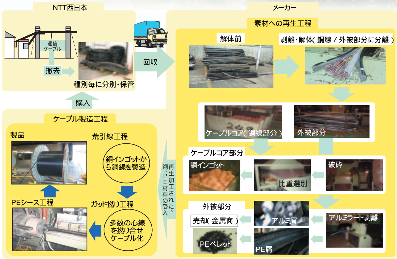
図6 通信ケーブルのリサイクルフロー
