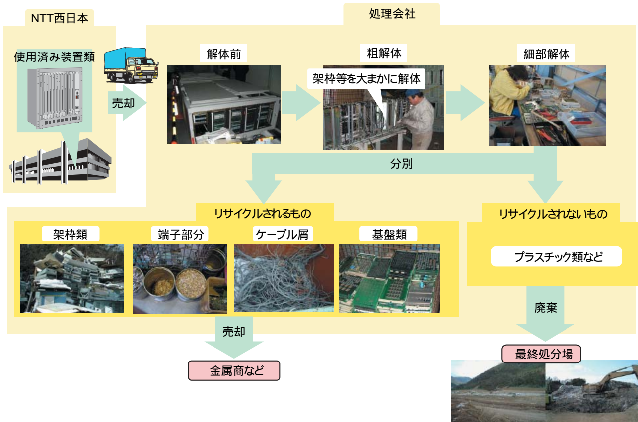
図7 交換機等装置類の処理フロー
