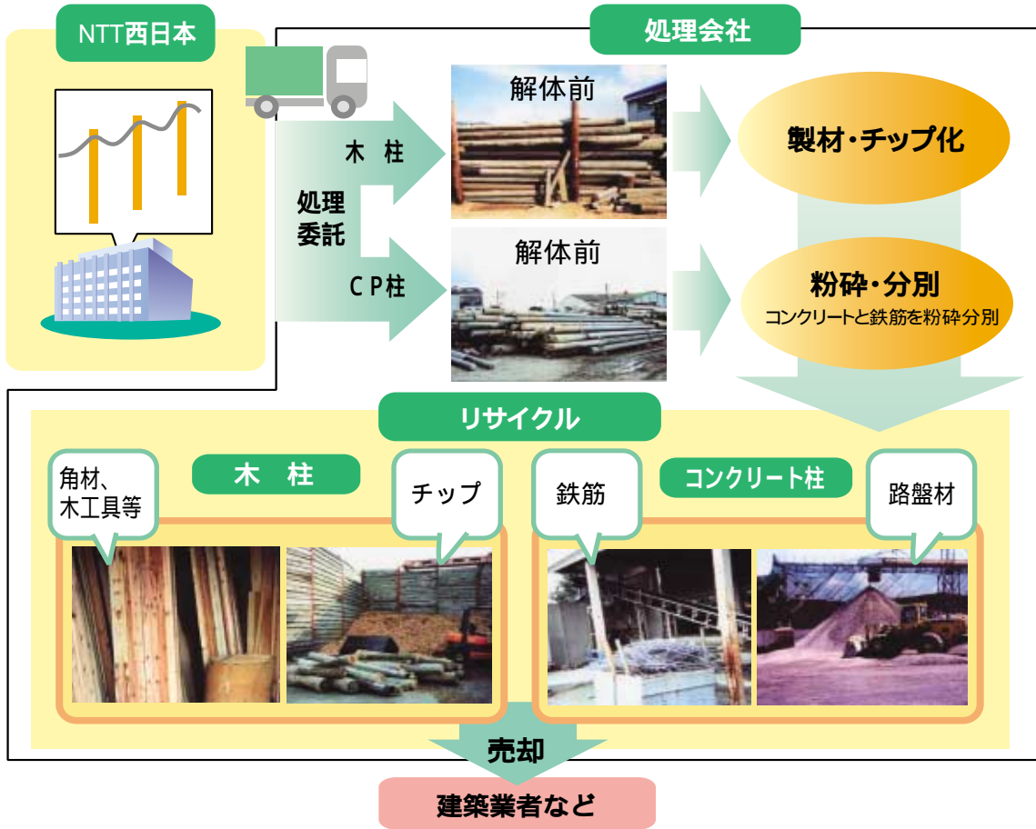
図3 電柱(コンクリート柱、木柱)の処理フロー
