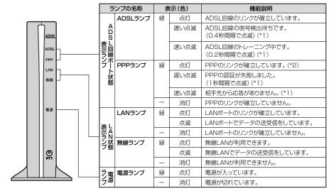
(\*1) ラインモードの拡張自動設定でリンク速度を接続確認中は、ADSLランプとPPPランプが同時に緑点滅します。 (\*2) 本商品起動時に数秒間緑点灯します。(セルフテスト実行中)
